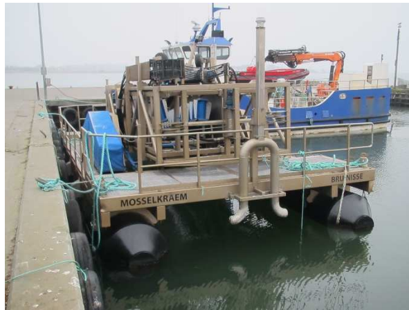
Figur 3.3 Høstbælterne er de blå bælter med hvide lameller, der her ses i midten på maskinen. Når de ikke er i brug, ligger de i vandret position på dækket af maskinen. Kilde: Hjørnø Havbrug
