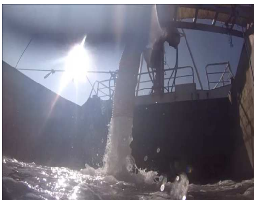
Figur 3.11 De høstede muslinger pumpes ned i lastrummet på følgebåden. Kilde: Hjarnø Havbrug.
