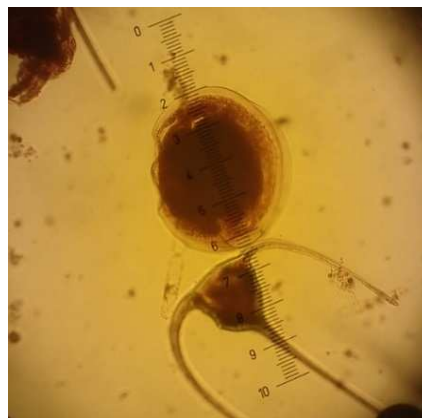
Figur 4.2 Opmåling af larve. Denne er 44 små streger hvilket svarer til 286 \mu\text{m} (200 X forstørrelse).
