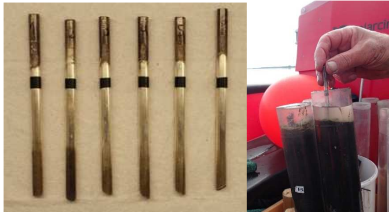
Figur 12.8 a og b. a: Et eksempel på sværtning af sølvpinde fra et kontrolleret laboratorieforsøg. Sværtning af sølvpindene ses nederst på stængerne. Den sorte markering øverst på stængerne angiver sedimentoverfladens placering. Bemærk at sværtningen af sølvpindene er stærkest dybt i sedimentet og at der kan registreres en glidende overgang fra stærk sværtning til ingen sværtning når man nærmer sig sedimentoverfladen. b: sedimentsøjler udtaget med kajak-rør med sølvpinde til bestemmelse af sulfid-front.
